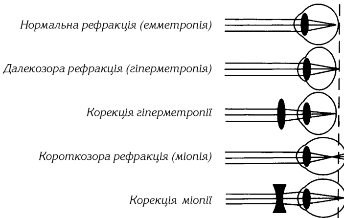
Рис. 13. Схема ходу променів через заломлюючу (оптичну) систему ока
