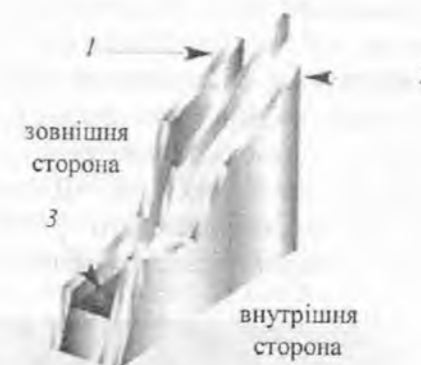
Рис. 5.7. Схема будови безпечного склопакета:
