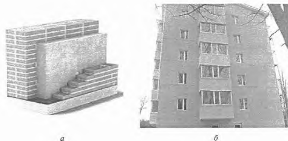
Рис. 12.3. Схема системи скріпленої ізоляції з використанням мінераловатної плити (а), фасад житлового будинку з використанням скріпленої теплоізоляції будинку (б)
