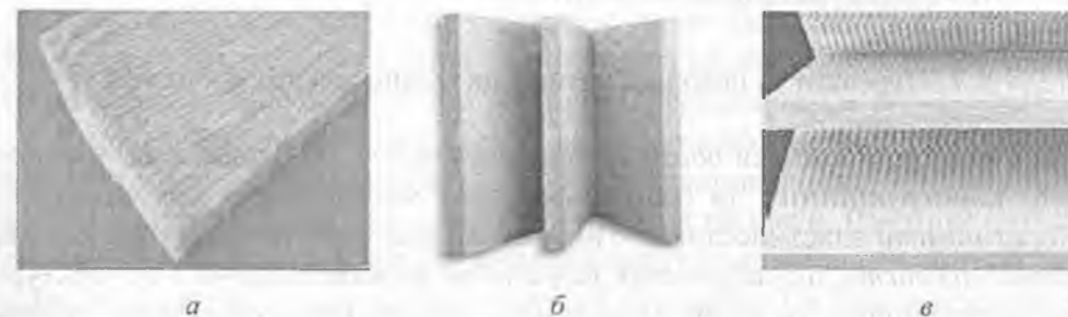
Рис. 5.24. Різновиди мінераловатних плит: а — м'які, б — напівжорсткі, в — жорсткі
