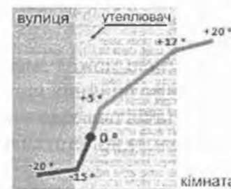
Рис. 12.1. Схеми огорожувальних конструкцій із різним розташуванням утеплювача
