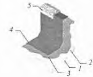
Рис. 9.5. Схема нанесення «рідкої гуми» на основу: 1 — бетонна основа; 2 — скіс (200 мм); 3 — шар мастики; 4 — шар «рідкої гуми» товщиною 2 мм; 5 — мембрана
